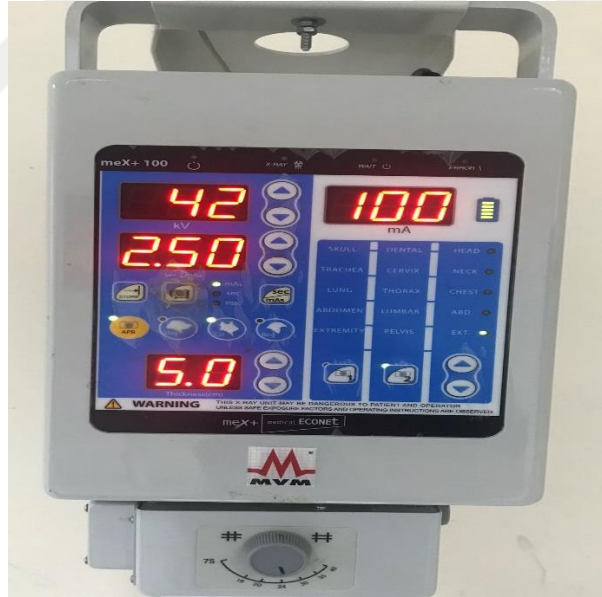
Şekil 3.17. Röntgen Cihazının Ratlara Göre Ayarlanması
