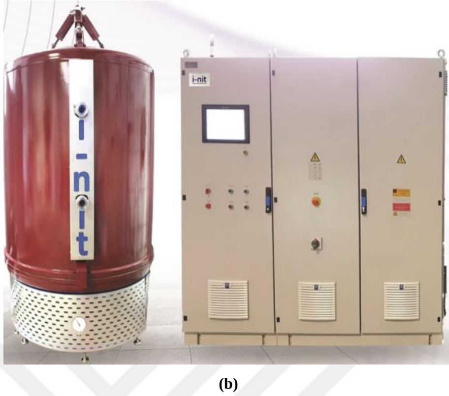
Şekil 26. Deneylerin gerçekleştirildiği plazma nitrürleme fırının şematik (a) (Karimoto and Nishimoto 2020) ve gerçek görünümü (b) (Anonim 2021) (devamı)
