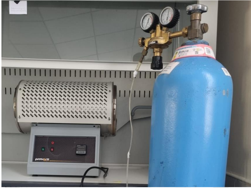
Şekil 33. Biyokömür eldesinde kullanılan silindir fırın ve Ar gaz tüpünün fotoğrafı.
