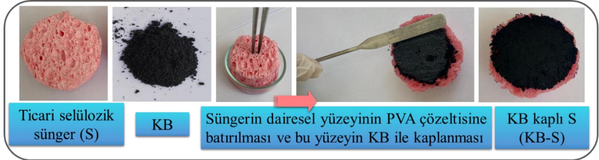
Şekil 43. Fototermal materyalin (KB-S) hazırlanmasına ait gösterim
