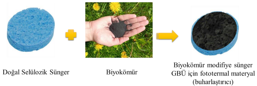
Şekil 23. GBÜ için fototermal buharlaştırıcının hazırlanmasına ait temsili gösterim
