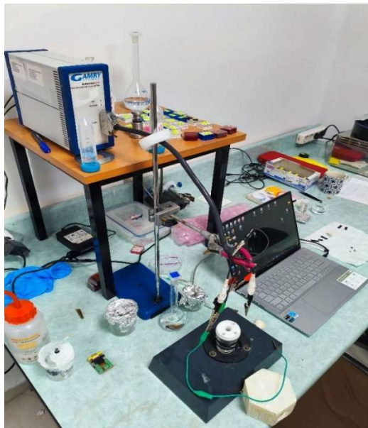
Şekil 31. CV, GCD ve EIS ölçümleri için kullanılan deney düzeneği
