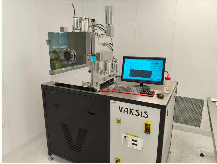
Şekil 23. Magnetron Saçtırma Sistemi
