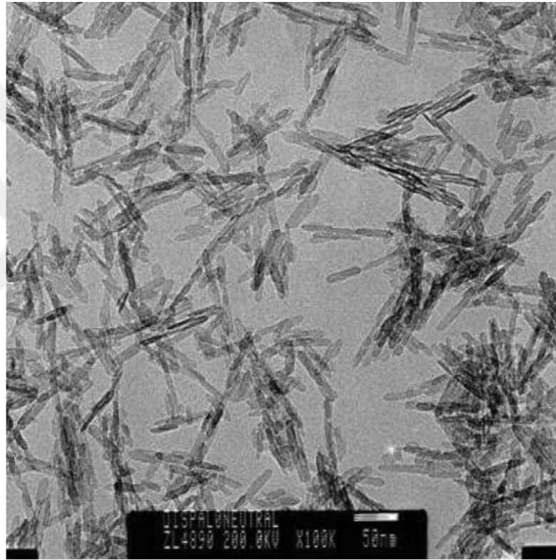
Şekil 3.188. Alümina nanopartiküllerinin TEM görüntüsü (Ji et al. 2013)
