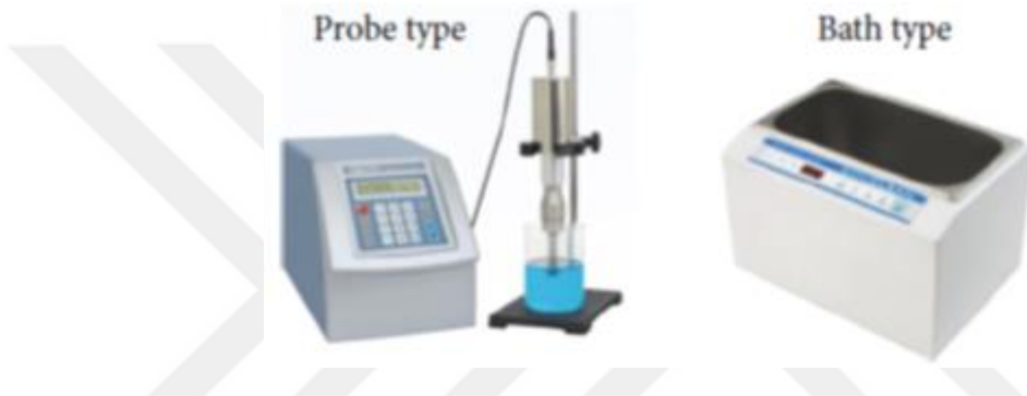
Şekil 2.8. Prob tipi ve banyo tipi ultrasonik karıştırıcı (Anonymous 2017a, Anonymous 2017b).
