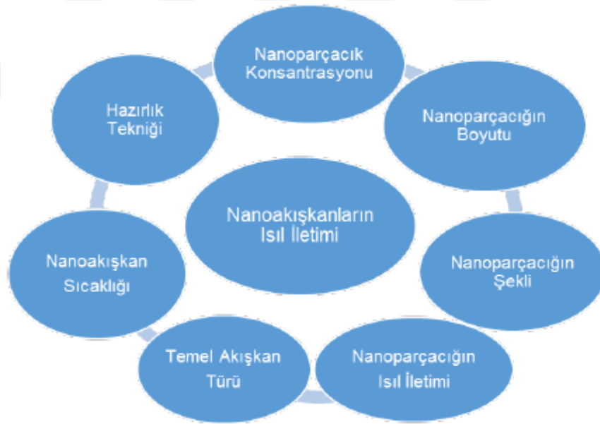
Şekil 2.10. Nanoakışkanların ısıl iletkenliğinin bağlı olduğu parametreler (Tawfik 2017)
