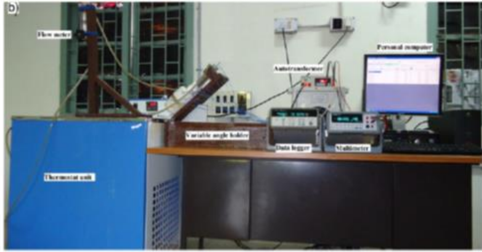
Şekil 3.90. (a) Isı borusu test bölümünün yerleşimi ve (b) Deney düzeneği (Kumaresan et al. 2014b)
