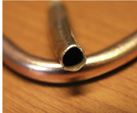
Şekil 3.11. Oluklu ısı borusunun kesit görünümü (Mehrali et al. 2016)
