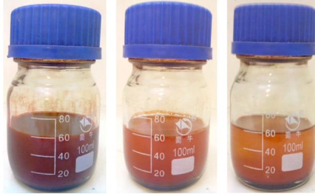
Şekil 3.203. Baz sıvıdaki ferro-akışkan nanopartiküllerin (I) 1 saat sonra (II) 1 gün sonra (III) 10 gün sonra tortu fotoğraf sonuçları (Goshayeshi et al. 2015)
