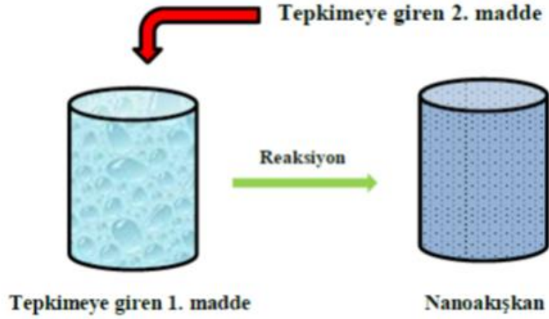
Şekil 2.2. Nanoakışkanların hazırlanmasında tek adım yöntemi (Mukherjee and Paria 2013)
