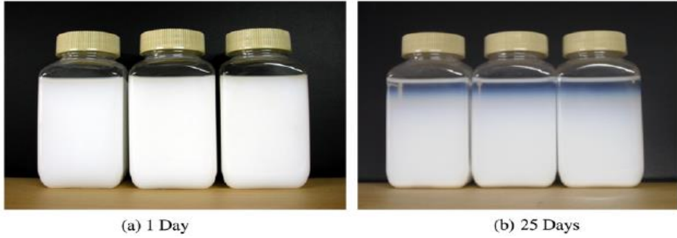
Şekil 3.32. Sedimentasyon Testi (Do et al. 2010a)
