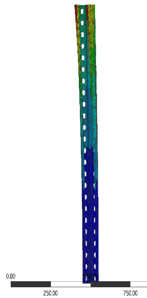
Şekil 130. 2.0C4 kolon kesiti için aksel basınç çözümlemesi sonuçları
