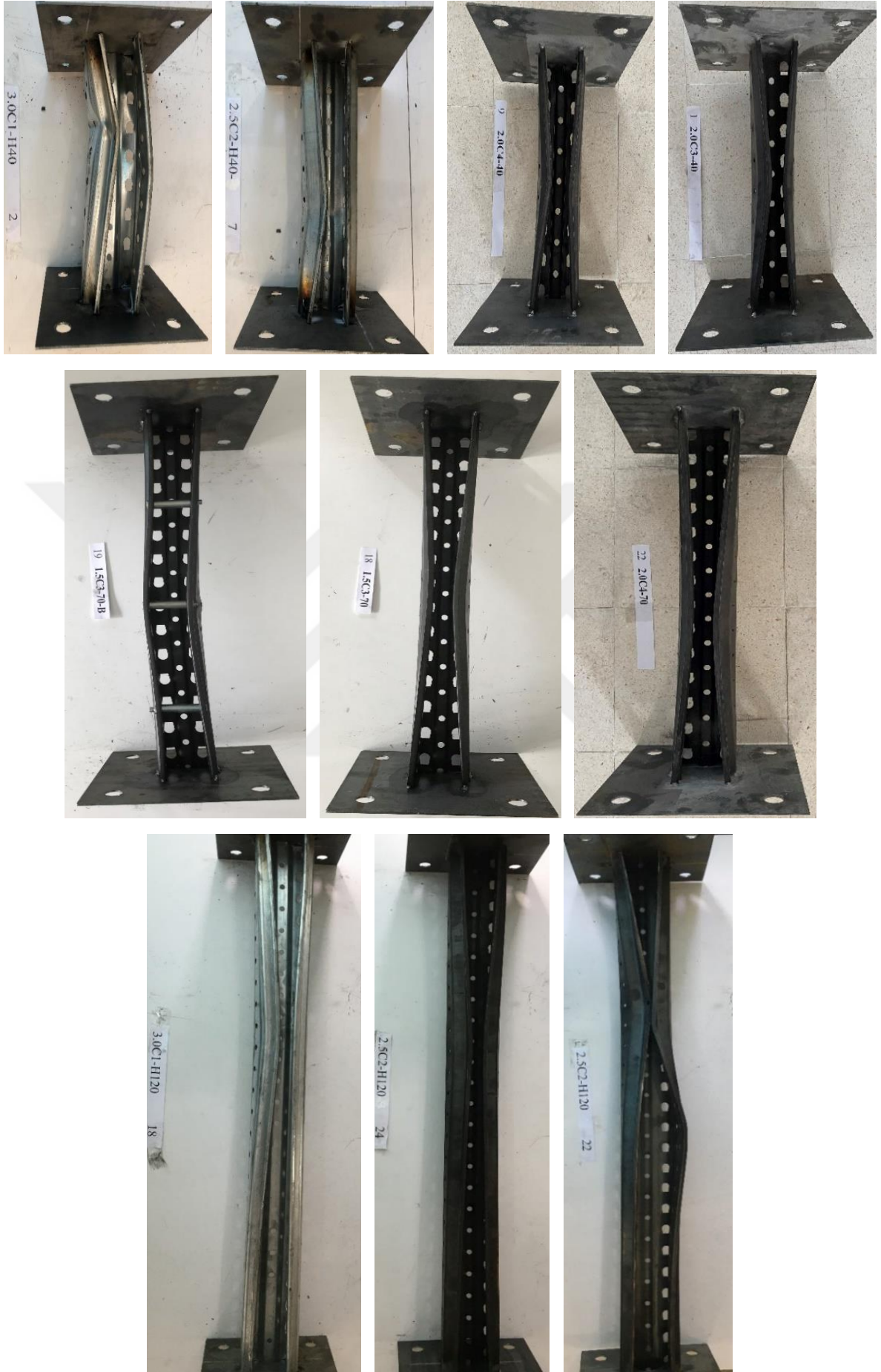
Şekil 77. Eksenel basınç deneylerinde görülen göçme modları
