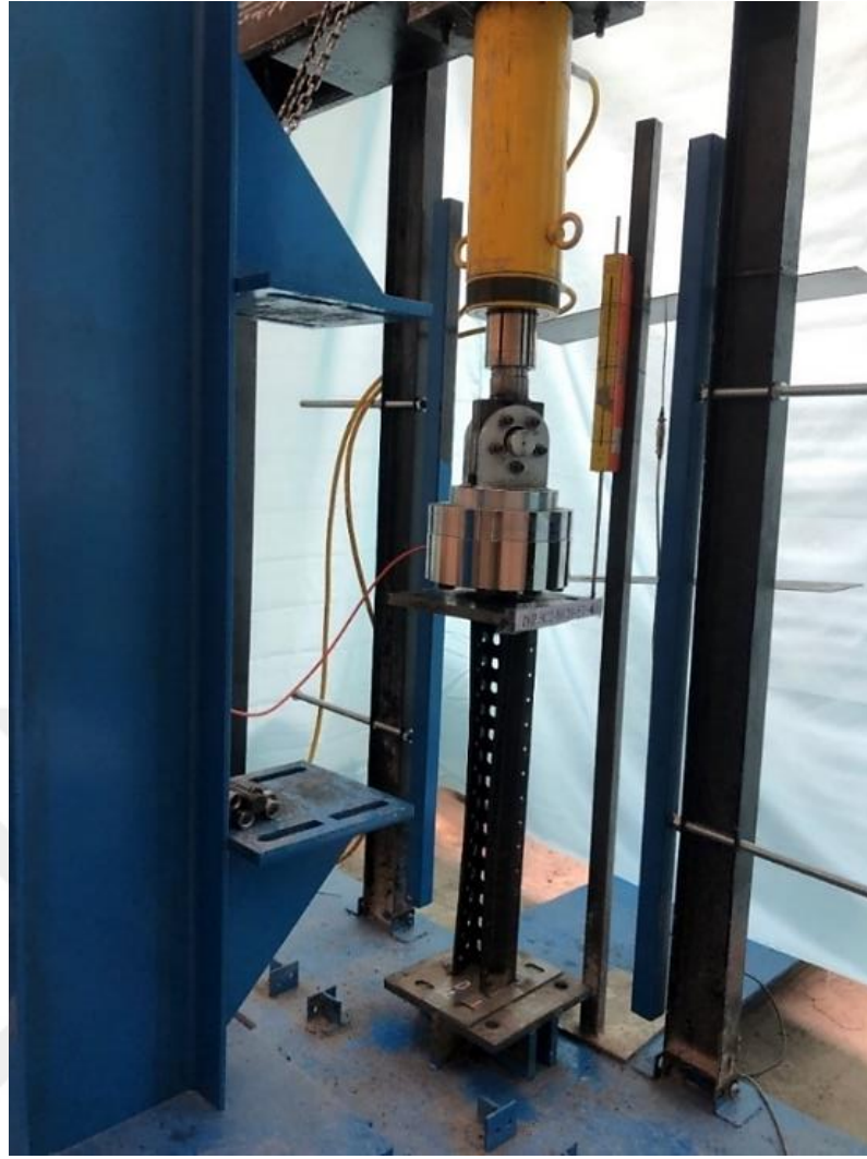
Şekil 41. Hasarlı kolonlar için eksenel basınç deney düzeneği
