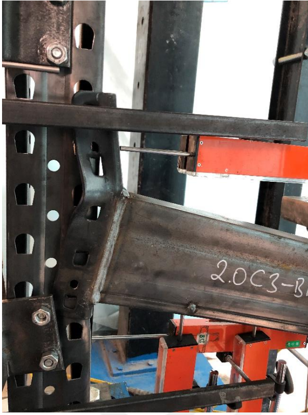
Şekil 126. 2.0C3-B120-5T+20 deney ve sayısal çözümleme karşılaştırması
