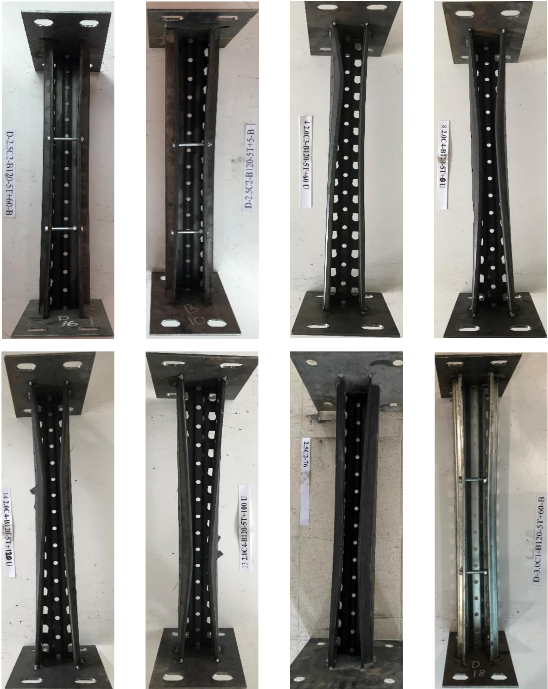
Şekil 83. Hasarlı kolonlar için eksenel basınç deneylerinde görülen göçme modları
