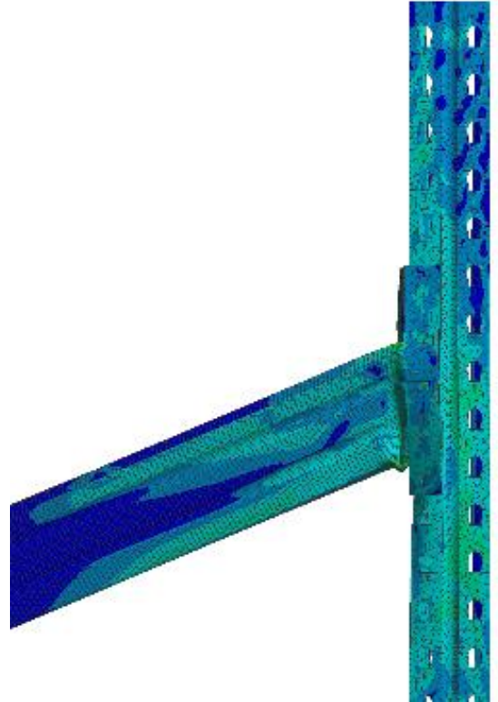
Şekil 127. 2.0C4-B120-5T+40 deney ve sayısal çözümleme karşılaştırması
