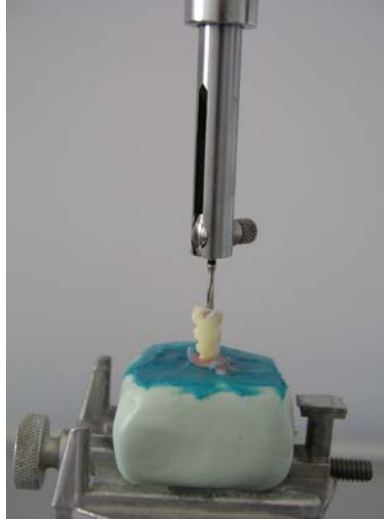
Şekil 1: Köklerin akrilik bloklara gömülmesi
