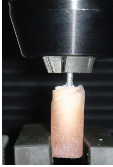
Şekil 5: Çekme test cihazına yerleştirilen örnek
