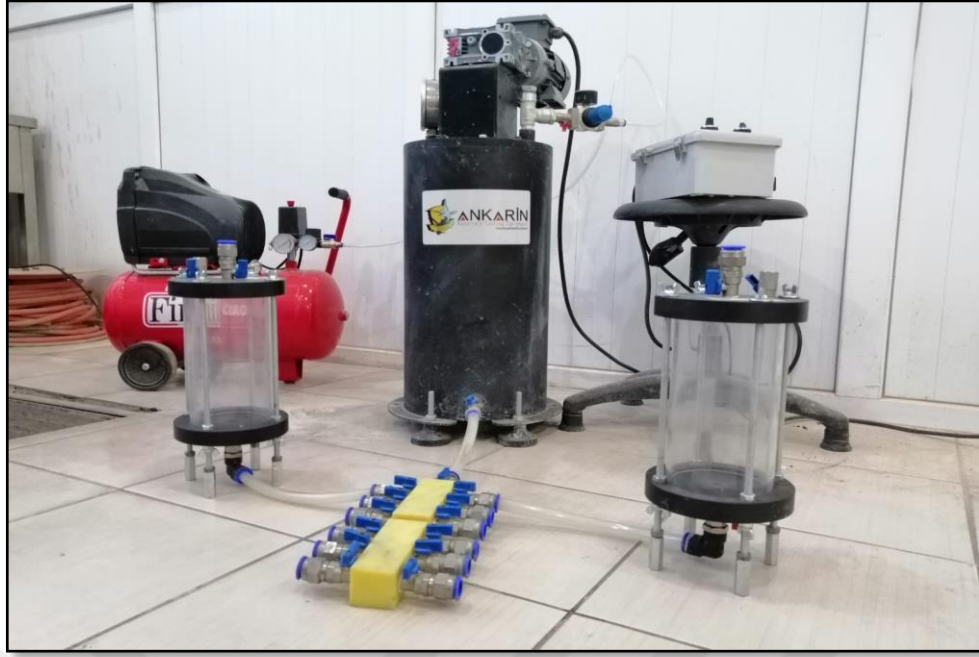
Şekil 20. Enjeksiyon sistemi ve numune kalıpları
