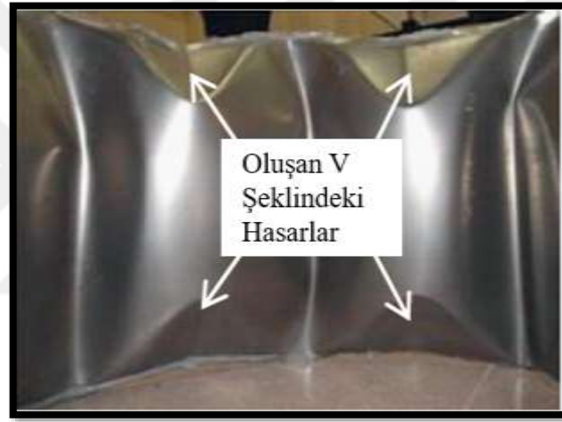
Şekil 6. Oluşan hasar çizgileri (Fatemi et al. 2013)
