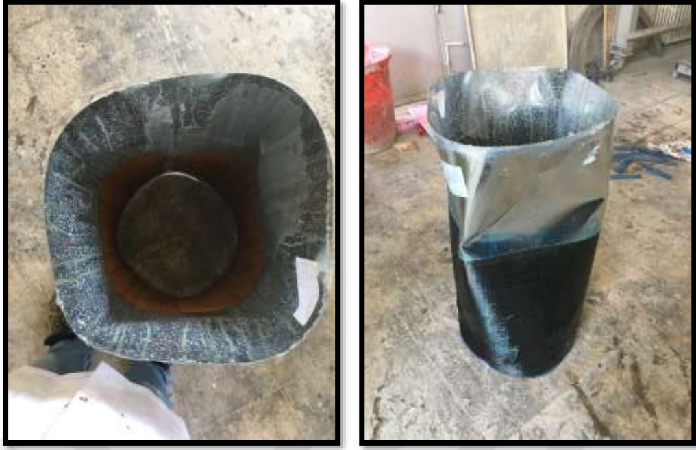
Şekil 69. S9-Y-A5-C400'ün burkulma sonrası durumu
