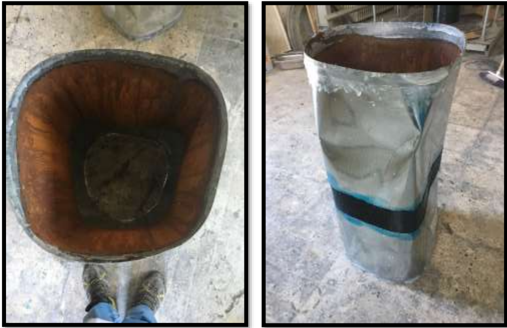
Şekil 65. S8-Y-A5-C100'ün burkulma sonrası durumu
