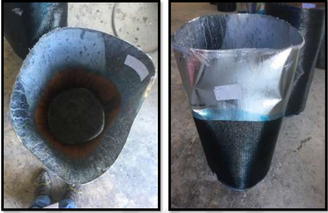
Şekil 53. S5-Y-A10-C400'ün burkulma sonrası durumu
