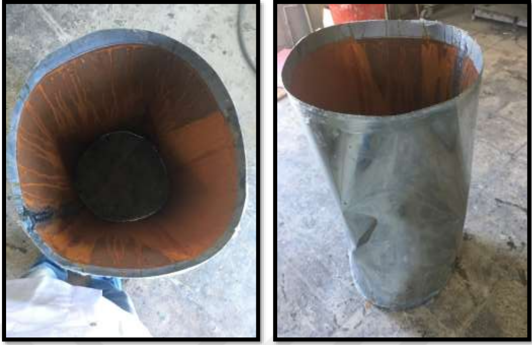
Şekil 45. S3-F-A5-CY'nin burkulma sonrası durumu
