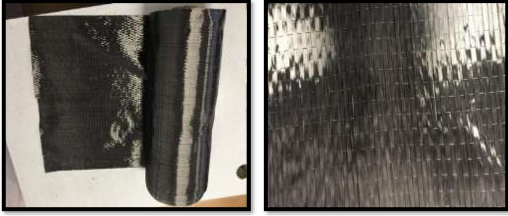
Şekil 9. Çalışmada kullanılan CFRP kumaş
