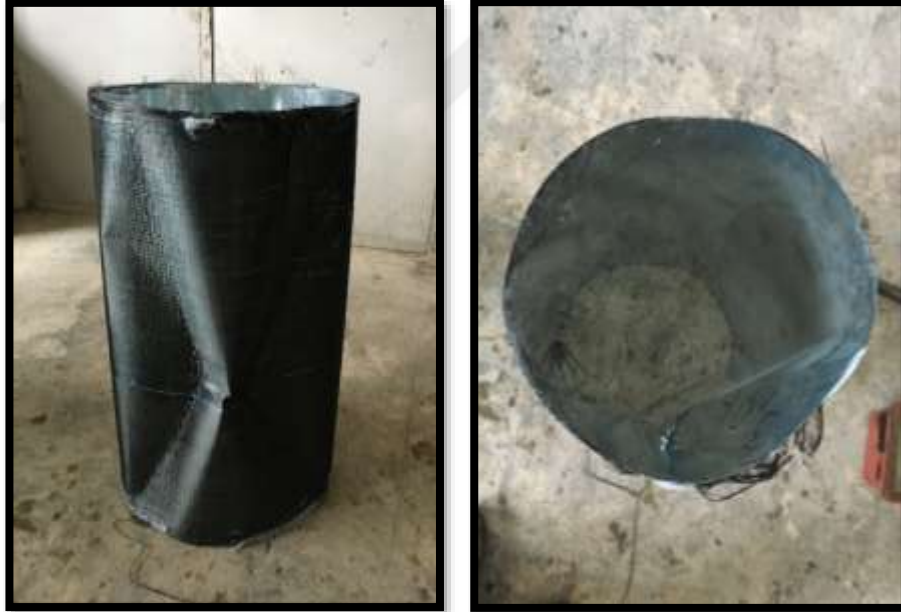
Şekil 33. Korozyonsuz CFRP'li silindirin burkulma sonrası durumu
