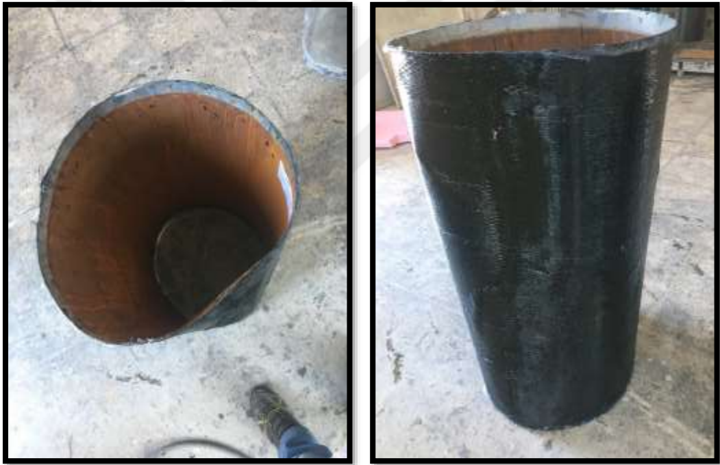
Şekil 49. S4-F-A5-CF’nin burkulma sonrası durumu
