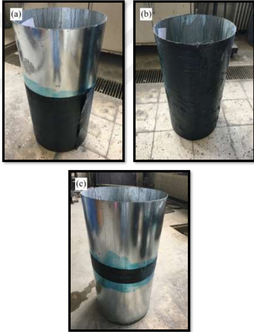
Şekil 20. %10 asit çözeltisiyle yarı dolu silindirlerin burkulma deneyi öncesi son durumu (a) S5-Y-A10-C400 (b) S6-Y-A10-CF (c) S7-Y-A10-C100.
