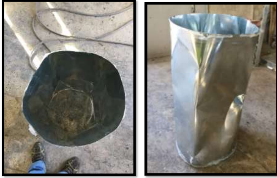
Şekil 29. Korozyonsuz CFRP'siz silindirin burkulma sonrası durumu
