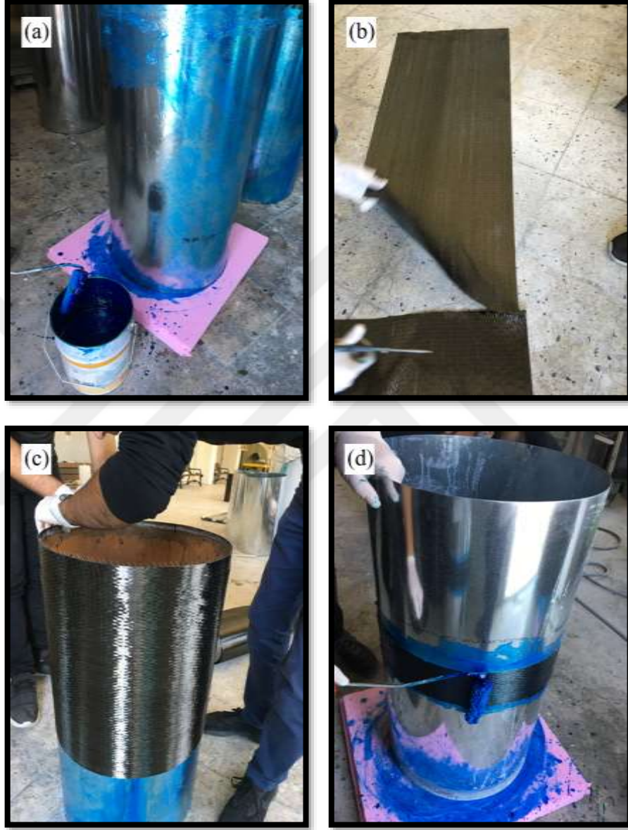
Şekil 16. CFRP uygulama aşamaları (a) silindir yüzeyine yapıştırıcı sürülmesi (b) uygun boyutta CFRP kumaş kesilmesi (c) silindir yüzeyine CFRP kumaş yapıştırılması (d) CFRP kumaş üzerine yapıştırıcı sürülmesi.
