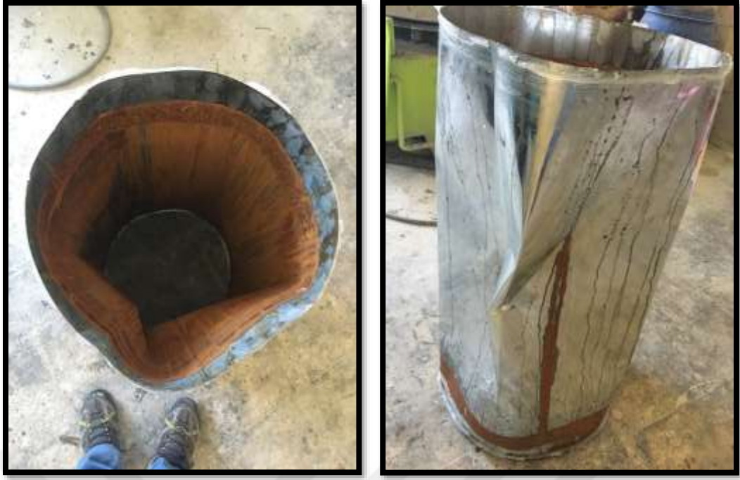
Şekil 37. S1-F-A10-CY'nin burkulma sonrası durumu
