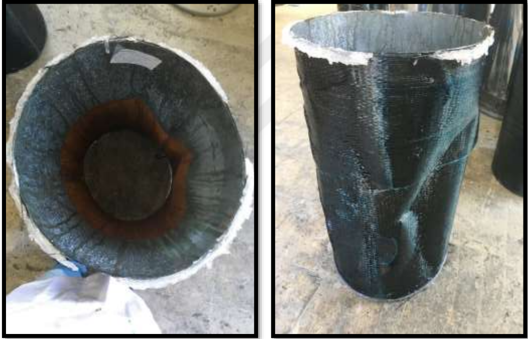
Şekil 57. S6-Y-A10-CF’nin burkulma sonrası durumu
