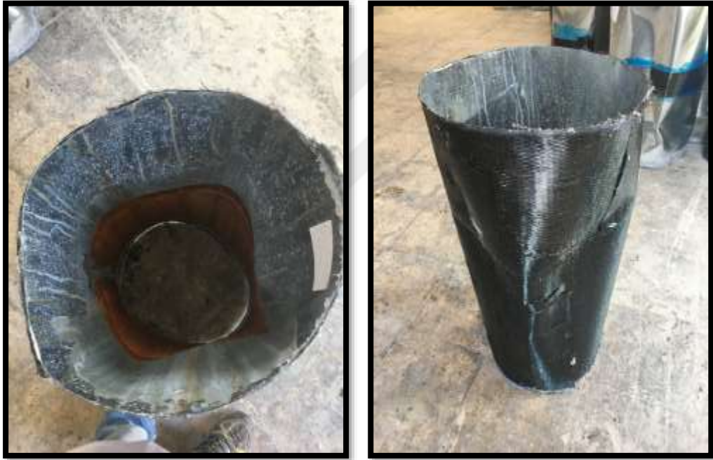
Şekil 73. S10-Y-A5-CF’nin burkulma sonrası durumu
