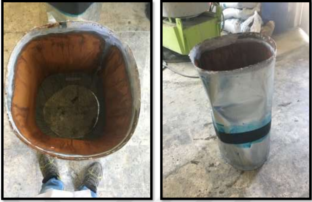
Şekil 61. S7-Y-A10-C100'ün burkulma sonrası durumu
