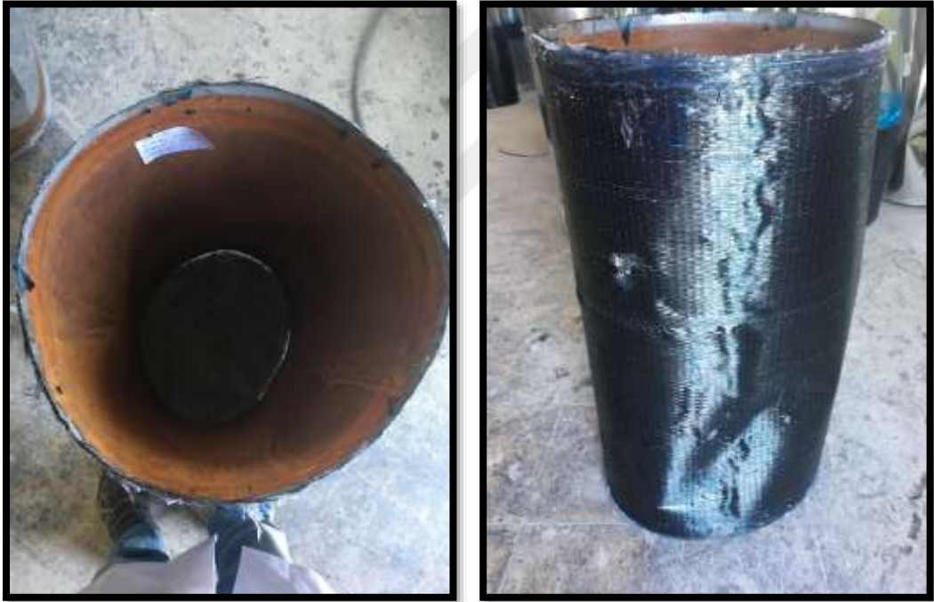
Şekil 41. S2-F-A10-CF’nin burkulma sonrası durumu
