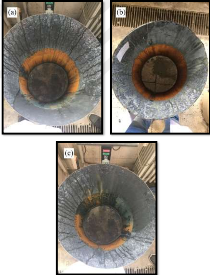
Şekil 26. %10 asit çözeltisiyle yarı dolu silindirlerin burkulma deneyi öncesi son durumu (a) S5-Y-A10-C400 (b) S6-Y-A10-CF (c) S7-Y-A10-C100.
