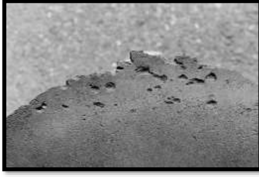
Şekil 4. Kırılma bölgesinde oluşan çukur korozyonu (Patané et al. 2002)
