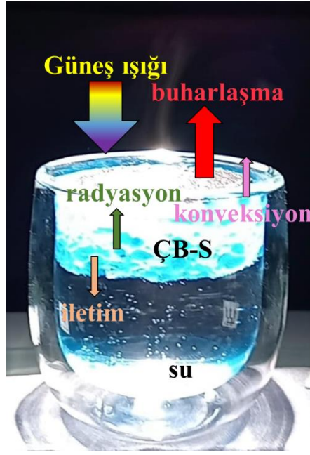
Şekil 52. ÇB-S fototermal malzeme için enerji dengesi ve ısı transferi diyagramı
