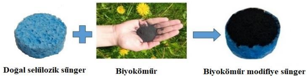
Şekil 25. GBÜ için biyokömür-çıkışlı materyal tasarımı
