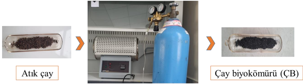
Şekil 31. Atık çay, piroliz işleminde kullanılan silindirik fırın ve Ar tüpü ve çay biyokömürünün (ÇB) fotoğrafları
