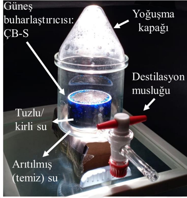
Şekil 56. ÇB-S ile güneş enerjisiyle tuzdan arındırma ve arıtma için deney düzeneği
