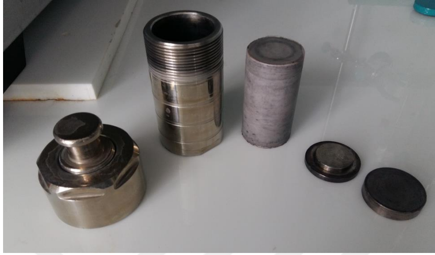
Şekil 35. WS 2 ve B 2 S 3 sentezinde kullanılan 50 ml’lik otoklav ve parçaları
