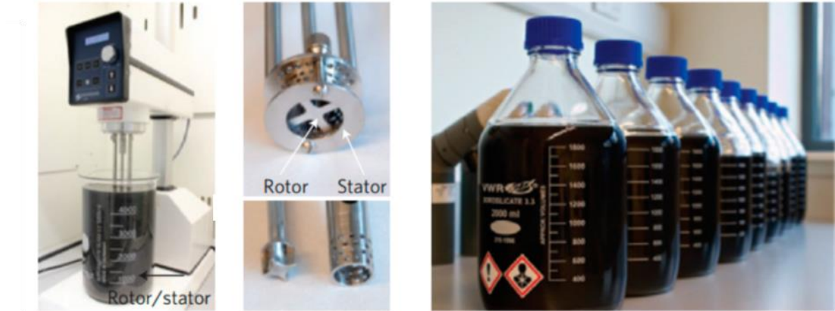
Şekil 29. Grafitin sonikasyon destekli sıvı pul pul yöntemi ile grafene dönüştürülmesinin şematik gösterimi (Tan et al. 2017)
