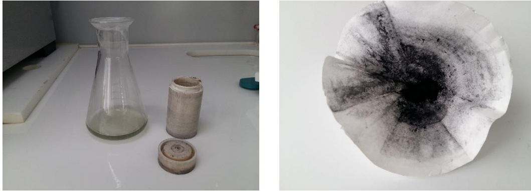
Şekil 45. Hidrotermal yöntem ile sentezlenen \text{Bi}_2\text{S}_3 'ün otoklavdan alınması ve süzülmesi
