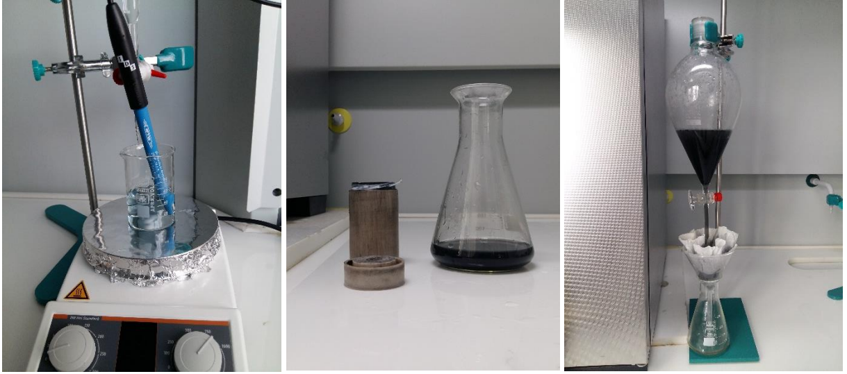
Şekil 36. Çözeltilerin hazırlanması, reaksiyon sonrası otoklavdan çıkarılması ve çökeleğin süzülmesi aşamalarının gösterilmesi
