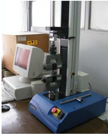
Şekil 3.20: Instron Universal test cihazı
