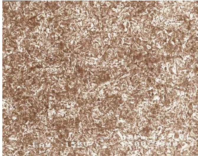
Şekil 4.7: Elmas frez ile pürüzlendirilmiş ve Co-Jet uygulanmış Ti-6Al-4V (×500)
