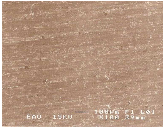
Şekil 4.2: Yüzey işlemi yapılmayan grup Ti-6Al-4V (×100)
