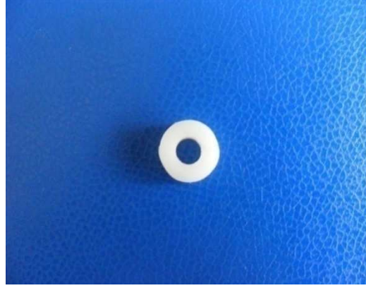
Şekil 3.12: Simantasyonda kullanılan teflon halka
