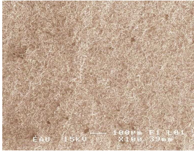
Şekil 4.8: Elmas frez ile pürüzlendirilmiş ve kumlama yapılmış Ti-6Al-4V ( \times 100 )
