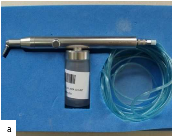
Şekil 3.7: a) Co-Jet Kumlama cihazı
