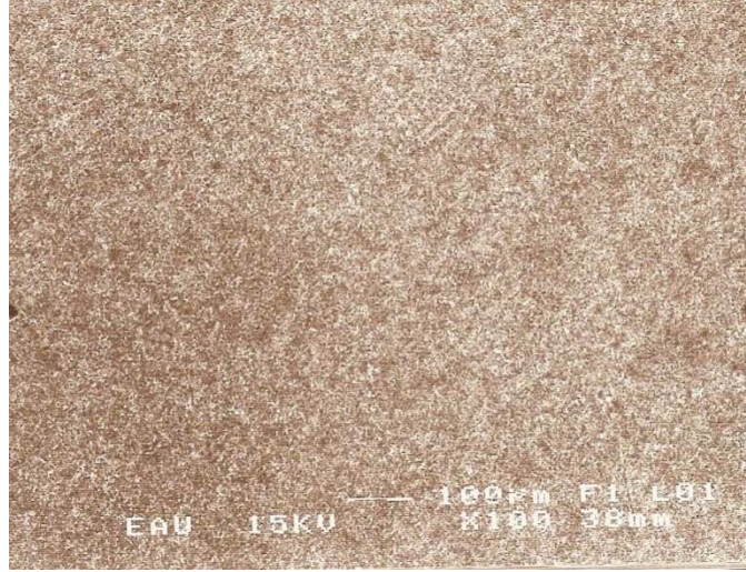
Şekil 4.4: Elmas frez ile pürüzlendirilen Ti-6Al-4V (×100)
