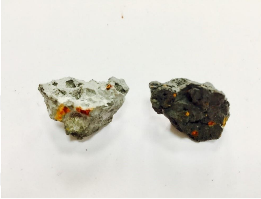
Şekil 15. Zırhlanmanın görüldüğü tane (sol) ve taze cüruf tanesi (sağ) (Yonar 2017)
