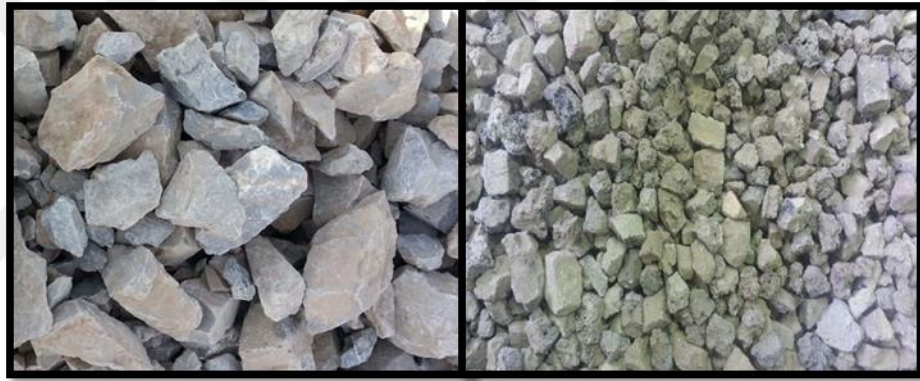
Şekil 27. a) Kireçtaşı balast b) Çelik cüruf balastı (Yonar 2017)
