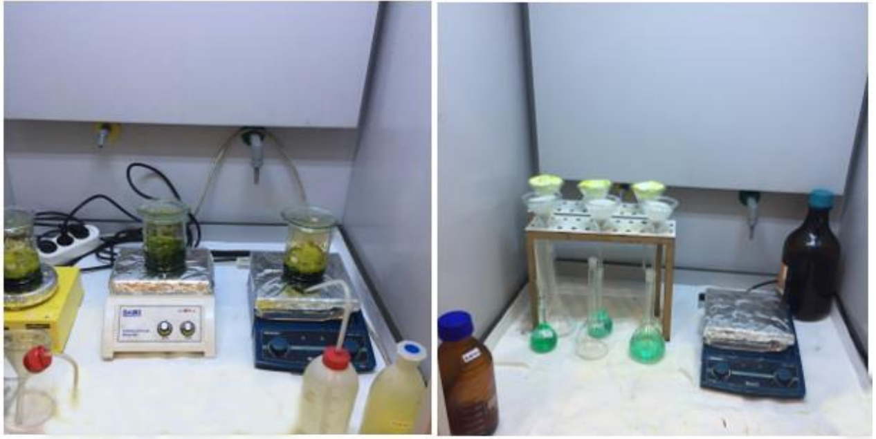
Şekil 27. Kral suyu çözündürmesine ait deney düzeneği
