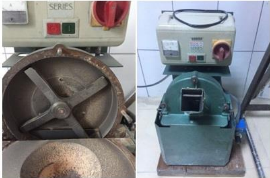
Şekil 23. Çapraz öğütücü değirmeni (Restch SK100)
