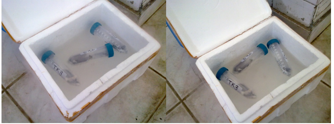
Şekil 3.6. Örneklerin sıvılaştırılmış azotta dondurulması
