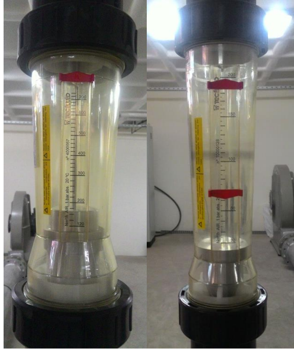
Şekil 3.3. Rotametreler, birincil ve ikincil hava (solda), loopseal hava (sağda)
