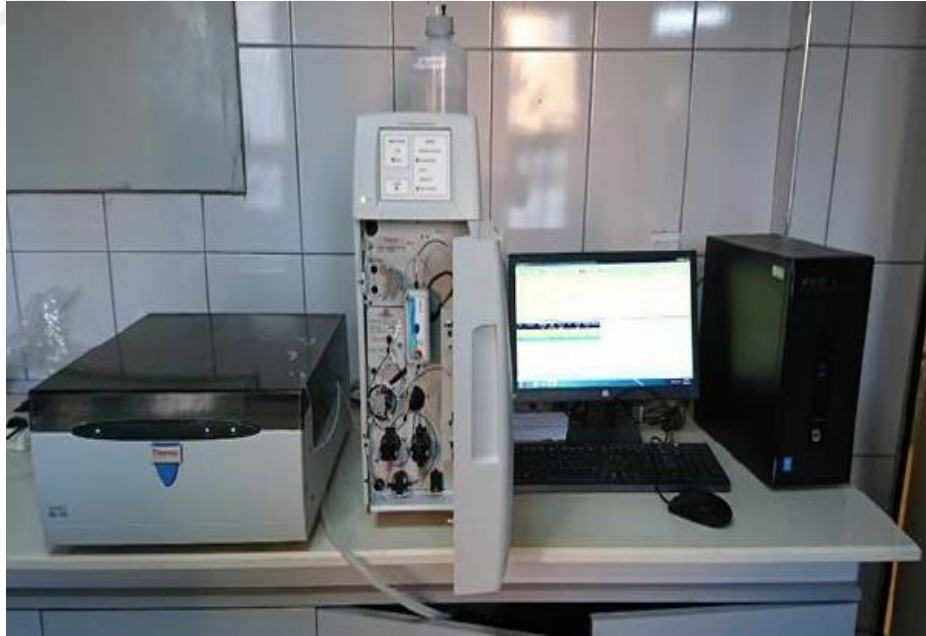
Şekil 24. Kasyon analizi için iyon kromatograf (Thermo Dionex ICS 1100)
