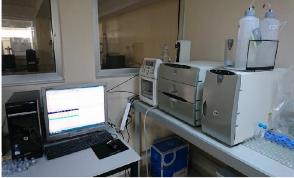
Şekil 26. Anyon analizi için iyon kromatograf (Thermo Dionex ICS 3000)
