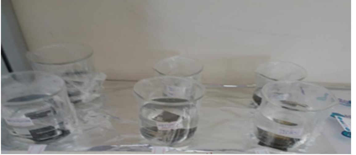
Şekil 4.3. HAP ve 0.05 M Zn/HAP ince film kaplı numuneler için çözelti dayanım test düzeneği
