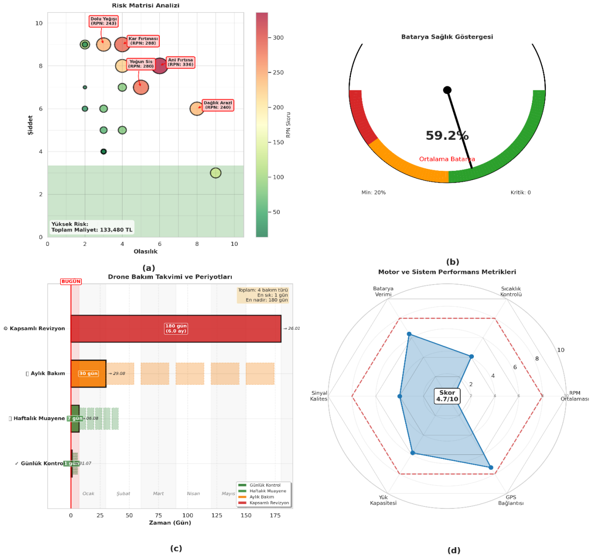
Şekil 25. Teknik analizler; (a) risk matrisi analizi, (b) batarya sağlık göstergesi, (c) drone bakım takvimi ve periyotları ve (d) motor ve sistem performans metrikleri.
