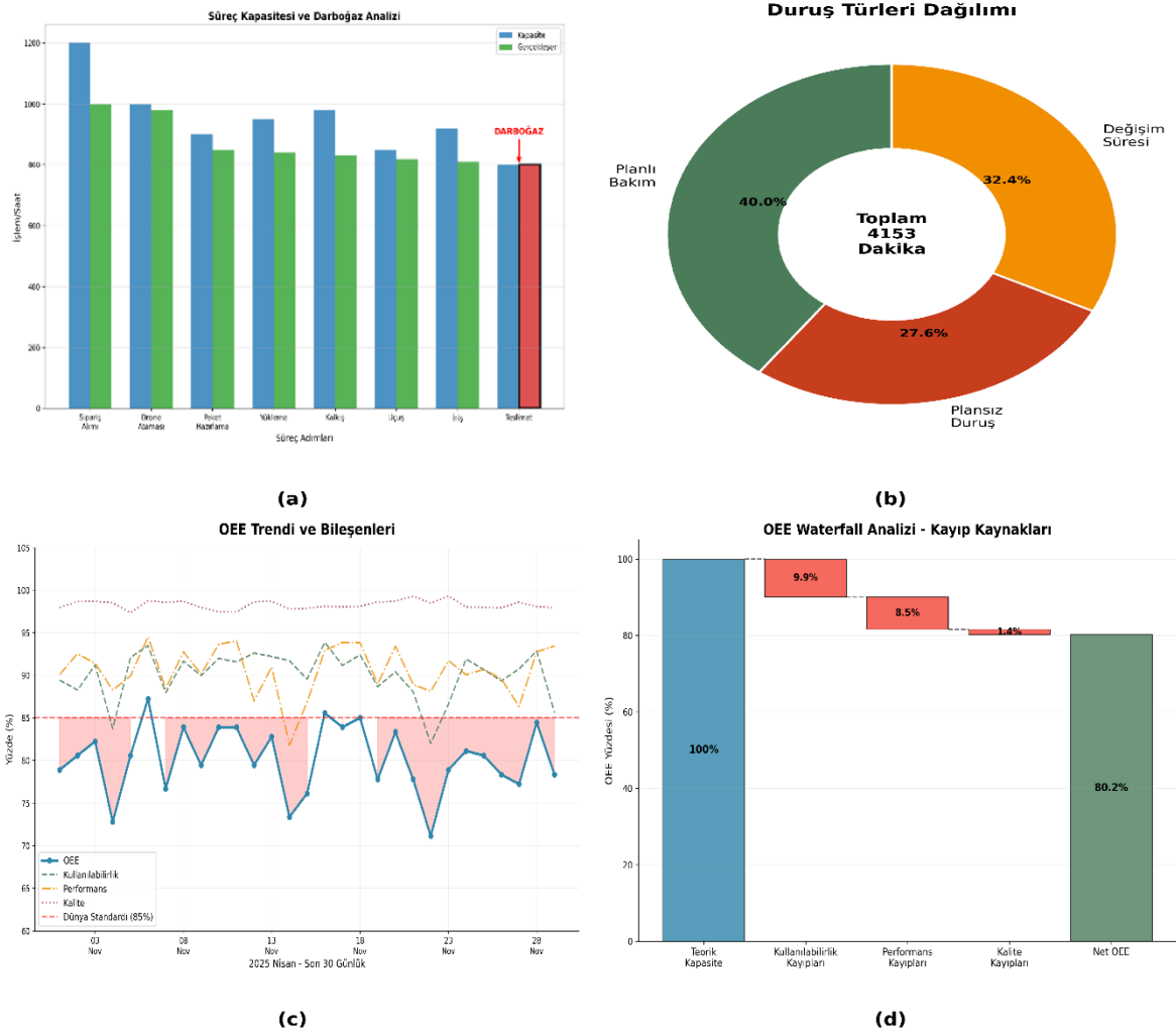
Şekil 28. OEE analizleri; (a) süreç kapasitesi ve darboğaz analizi, (b) duruş türleri dağılımı, (c) OEE trendi ve bileşenleri ve (d) OEE waterfall (şelale) analizi-kayıp kaynakları.
