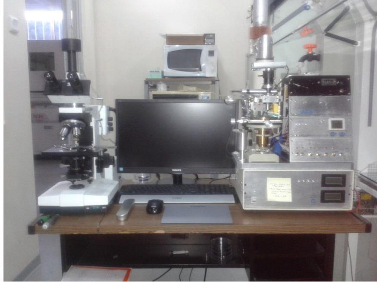
Şekil 3.8. Hizalama ve pozlandırma cihazı
