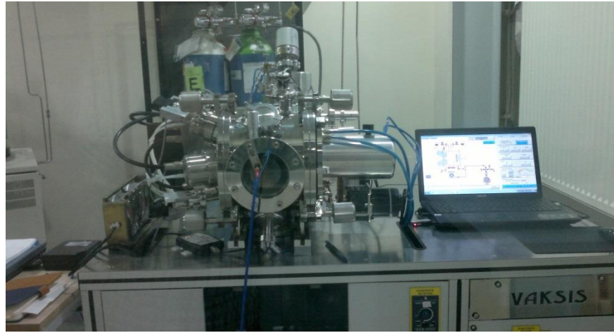
Şekil 3.2. Üç hedefli saçırma sistemi
