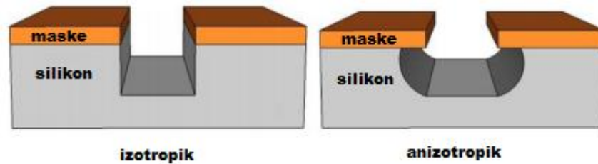
Şekil 3.12. İzotropik ve Anizotropik aşındırma (Nayak 2012)
