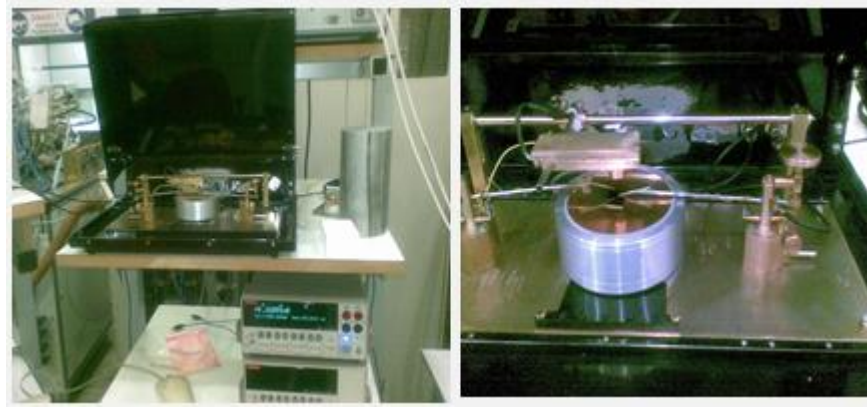
Şekil 4.1. I-V ölçüm için prob istasyonu
