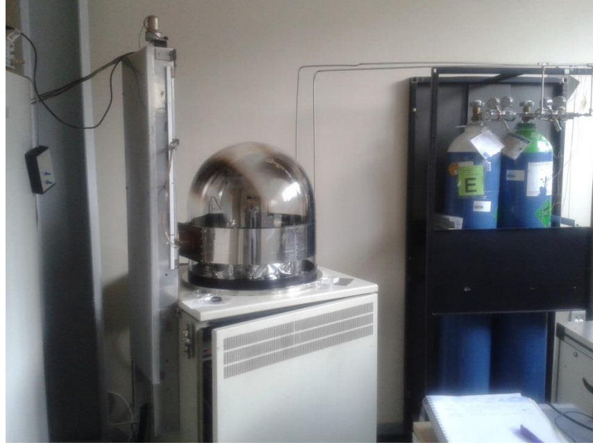
Şekil 3.14. Termal buharlaştırma sistemi
