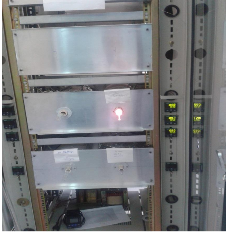
Şekil 3.15. Oksitlemek için kullanılan fırın
