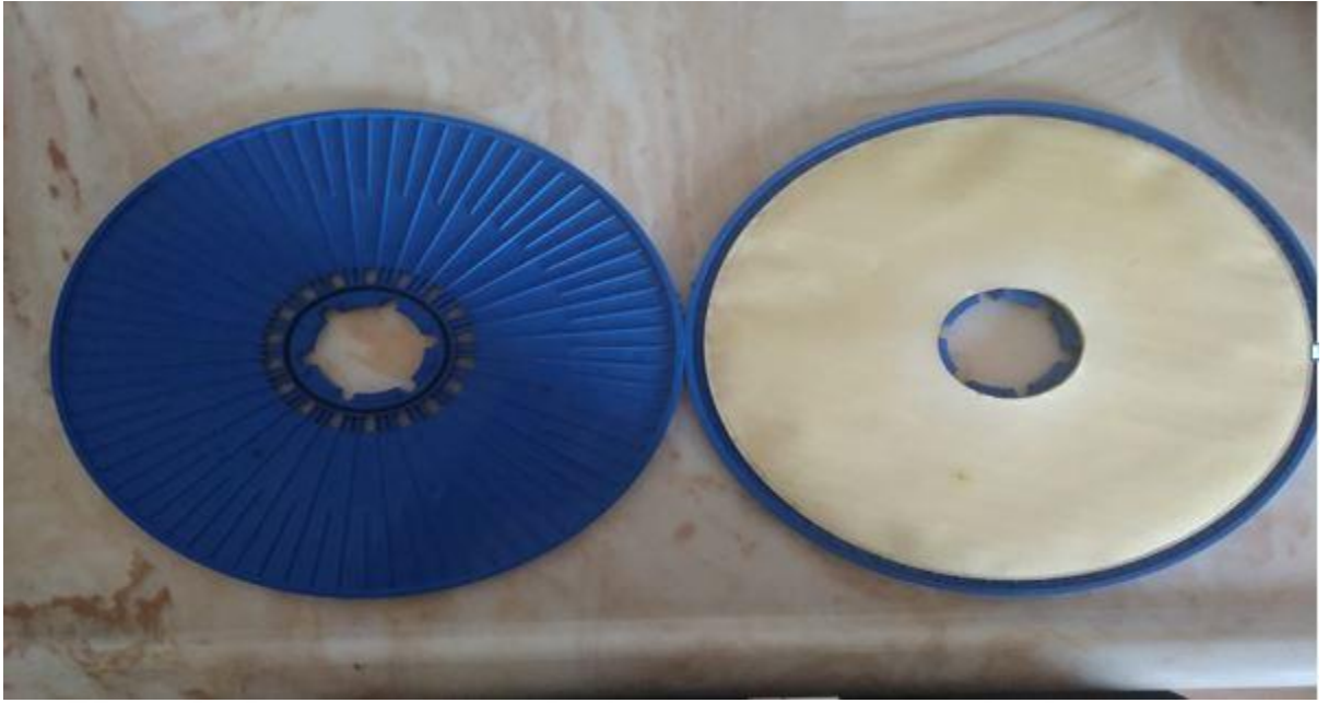
Şekil 26. Sızıntı suyu arıtımında kullanılan disk tüp membran
