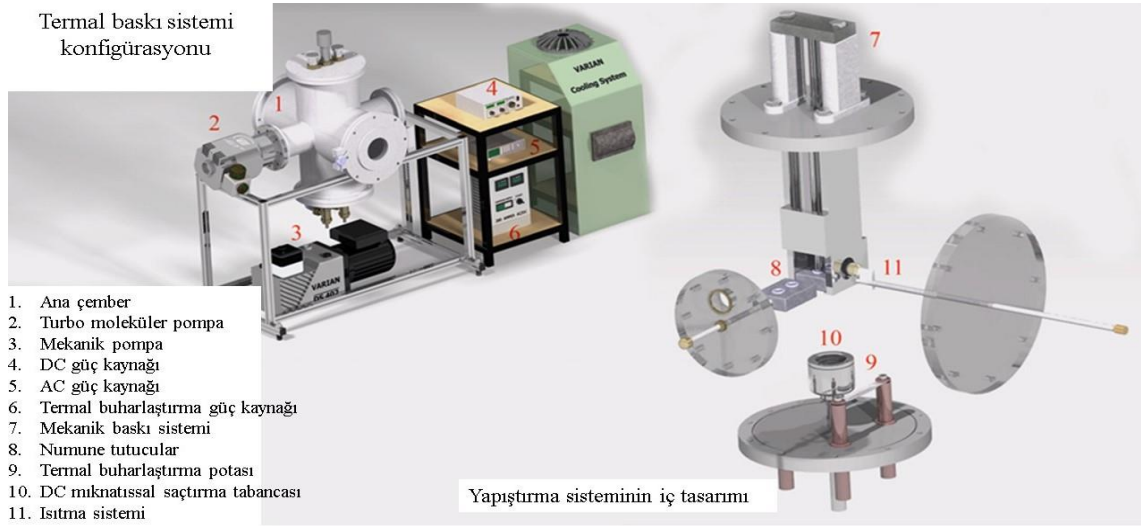
Şekil 18. Termal baskı sistemi ve konfigürasyonu ve ayrıntıları
