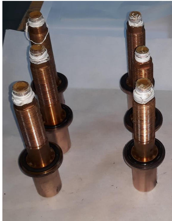
Şekil 19. Termal feedthrough elektrik kontakları
