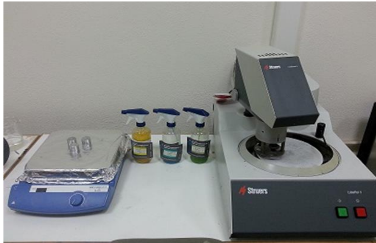
Şekil 30. Zımpara cihazı ve inceltme malzemeleri
