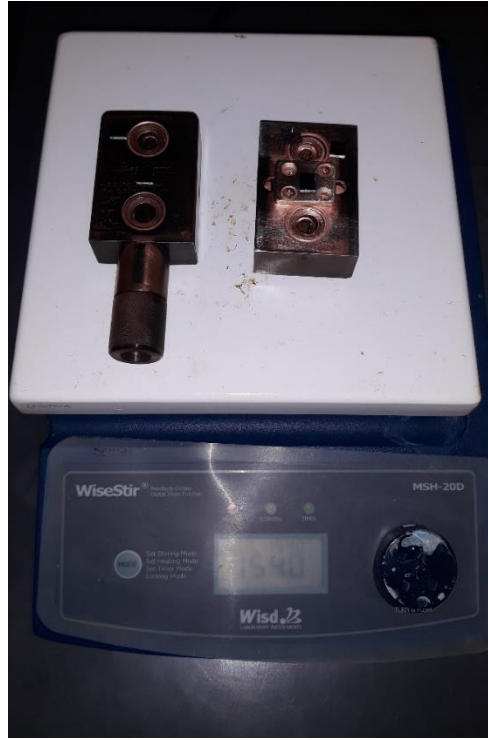
Şekil 33. Hotplate üzerinde numune yapıştırma prosedürü
