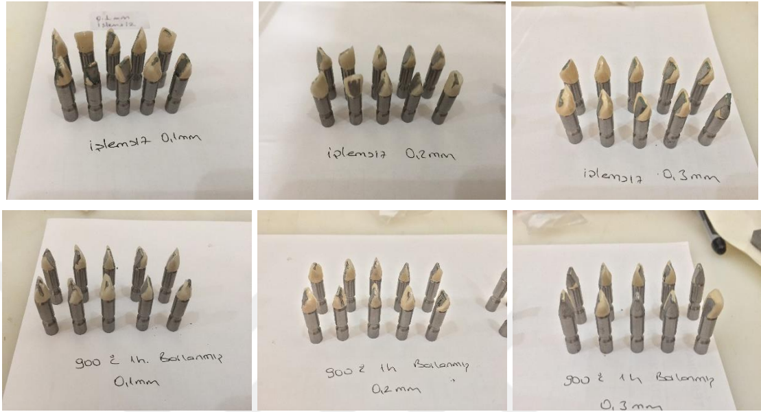
Şekil 4.17. İşlemsiz, 900°C 1 Saat borlanmış 0,1-0,2-0,3 mm kırılmış numunelere ait resimler
