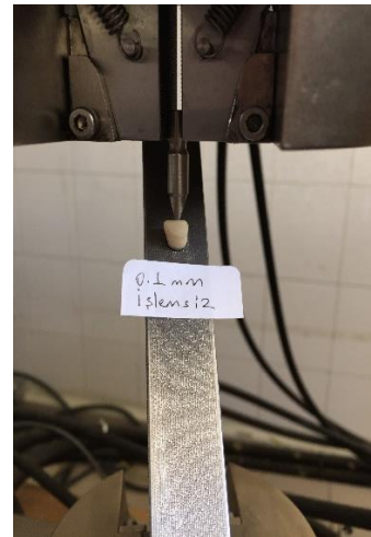
Şekil 3.9. INSTRON 8872 Çeki-Bası yorulma test cihazı şematik ve uygulama gösterimi
