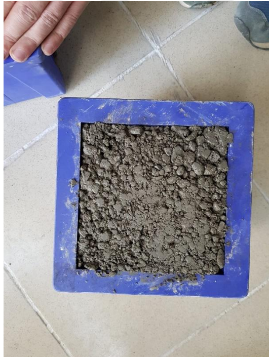
Şekil 3.10. Karışımın kalıplara yerleştirilmesi
