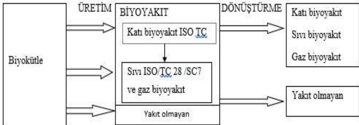
Şekil 12. Biyokütle, biyoyakıt ve biyoenerji arasındaki etkileşim (ISO/TC 238)
