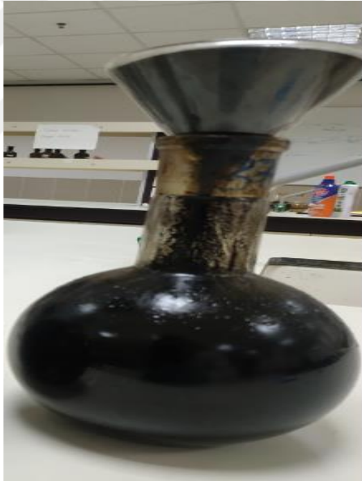
Şekil 44. Preasfalten+Asfalten ve yağ
