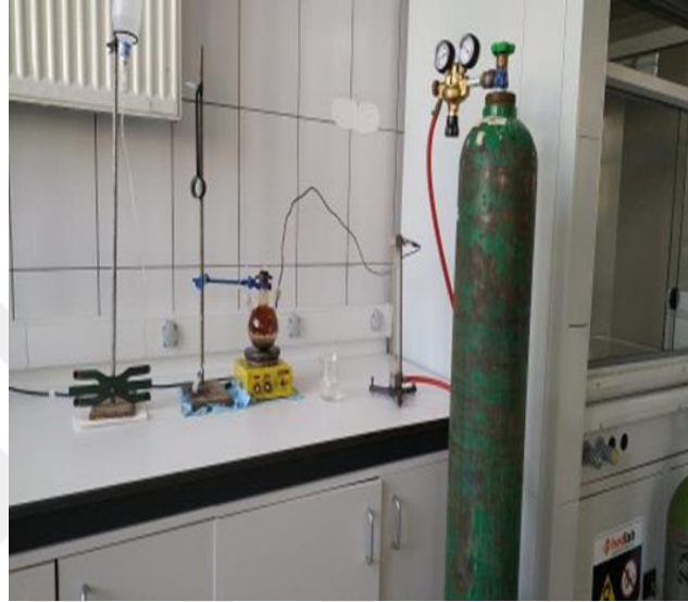
Şekil 28. SD/NZVI katalizörü hazırlamada kullanılan deney düzeneği
