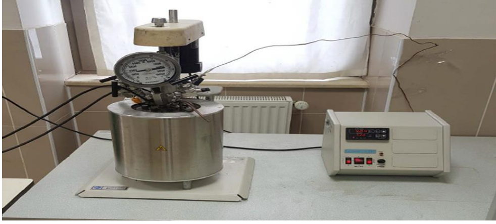
Şekil 32. Deneylerde kullanılan basınçlı reaktör ve kontrol ünitesi
